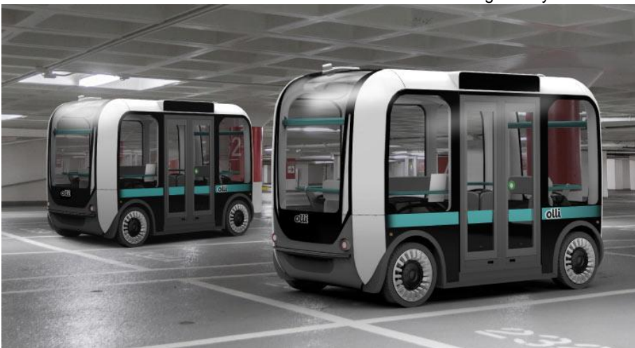
Der erste 3D gedruckte, selbstfahrende Kleinbus der Welt existiert schon. Er heißt Olli, wird von der open-source-company „Local Motors“ gedruckt und fährt mit der KI von IBM Watson.
